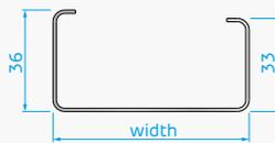
GTEC C Stud – Y gauge (CS)
