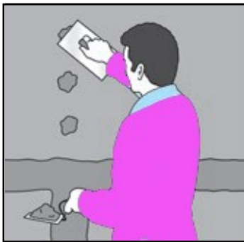
Малюнок 17.6 Шпаклівка Cementex PM Finisher на місцях кріплення плит CEMENTEX
