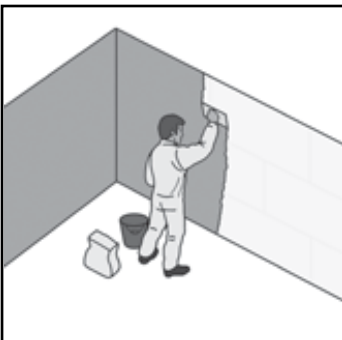
Малюнок 17.11 Нанесення декоративної штукатурки
